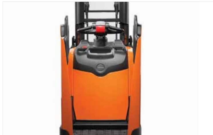
Zijbeschermingen en E-man besturing om comfortabel en veilig lange afstanden af te leggen
