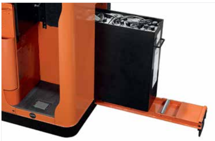
De batterij van de S-serie is op rollen geplaatst met een ingebouwde batterijtafel zodat de batterij gemakkelijk zijdelings kan worden verwisseld
