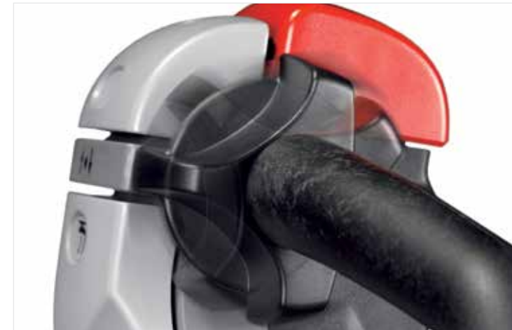
Ergonomische bedieningshendel met veiligheidsomkeerinrichting. Deze zet de truck, indien ingedrukt, kort in zijn achteruit.
