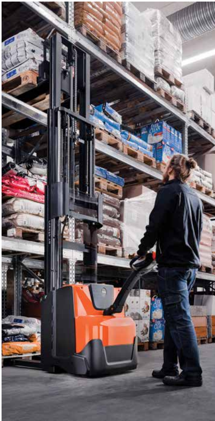
De stuurarm lengte is ontworpen voor een optimale veiligheid en zorgt dat de voeten uit de buurt van de truck blijven
