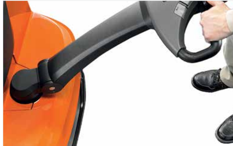
De stuurarm lengte is ontworpen voor een optimale veiligheid en zorgt dat de voeten uit de buurt van de truck blijven
