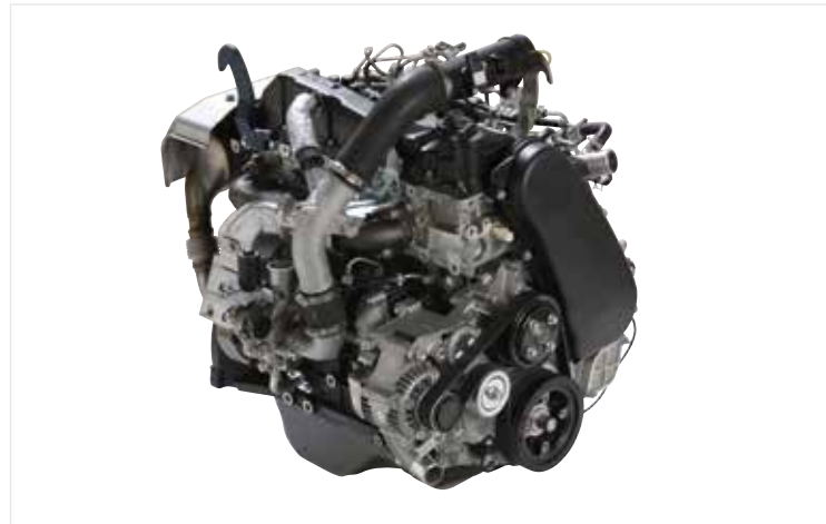
Schone en ultramoderne Toyota 1KD-dieselmotor met common-rail
