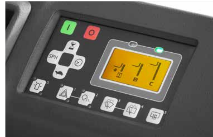
Vooraf ingestelde hefhoogte bespaart de bestuurder tijd en moeite
