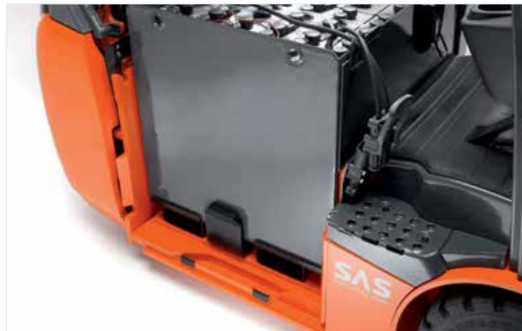
Zijdelingse batterijwisseling met vorkuitsparingen (afgebeeld) of ingebouwd rollenbed
