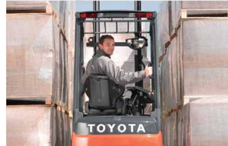
Achteruitrijhandgreep verbetert het comfort bij achteruitrijden en verhoogt de productiviteit door minder belasting van de rug. Optionele draaistoel voor meer comfort bij het achteruitrijden en in- en uitstappen
