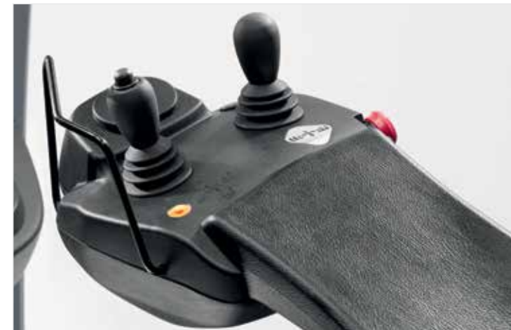
Diverse hydraulische besturingen, van standaard minihendels tot optionele multifunctionele hendels (afgebeeld)
