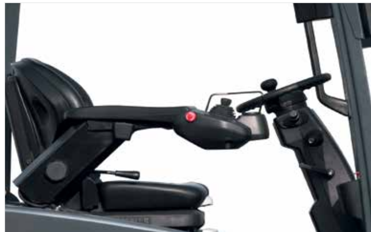
De minihendels in de armsteun bieden een soepele vingertipbediening voor het heffen, dalen, kantelen en voor sideshift-functies
