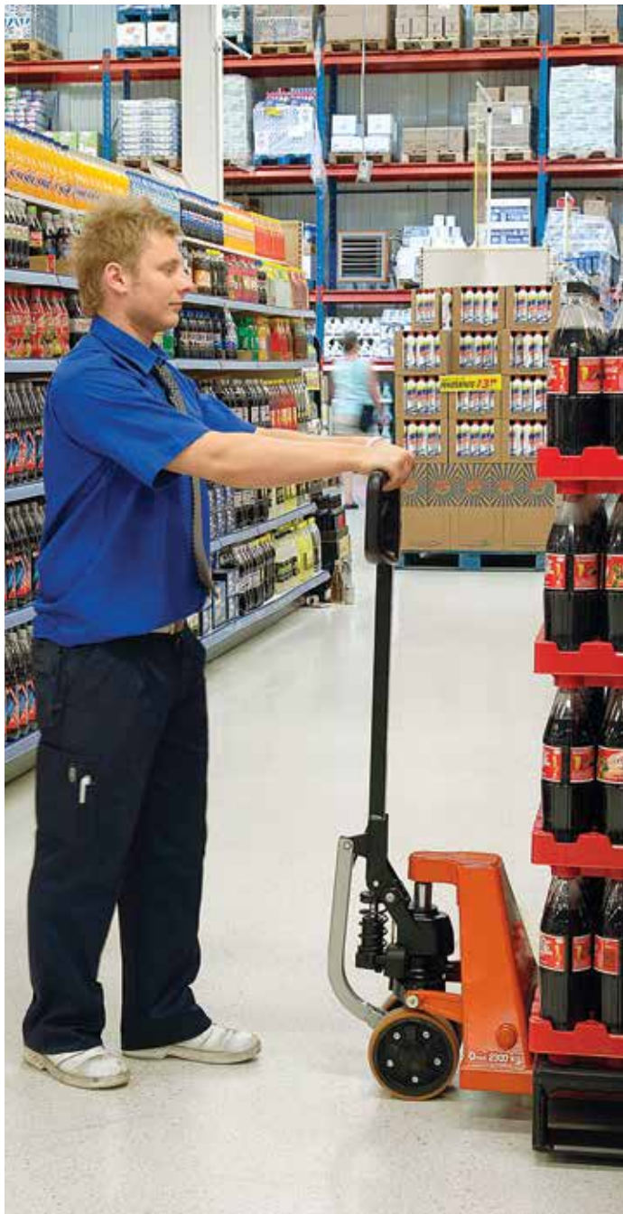
De stuurarm van de BT Pro Lifter maakt gebruik van een hefboomwerking op de wielen om de wagen in beweging te krijgen
