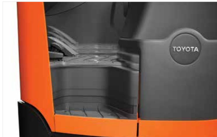
Het bestuurderscompartiment is aanpasbaar aan het postuur van de bestuurder. De vloerhoogte is handmatig of elektronische verstelbaar.
