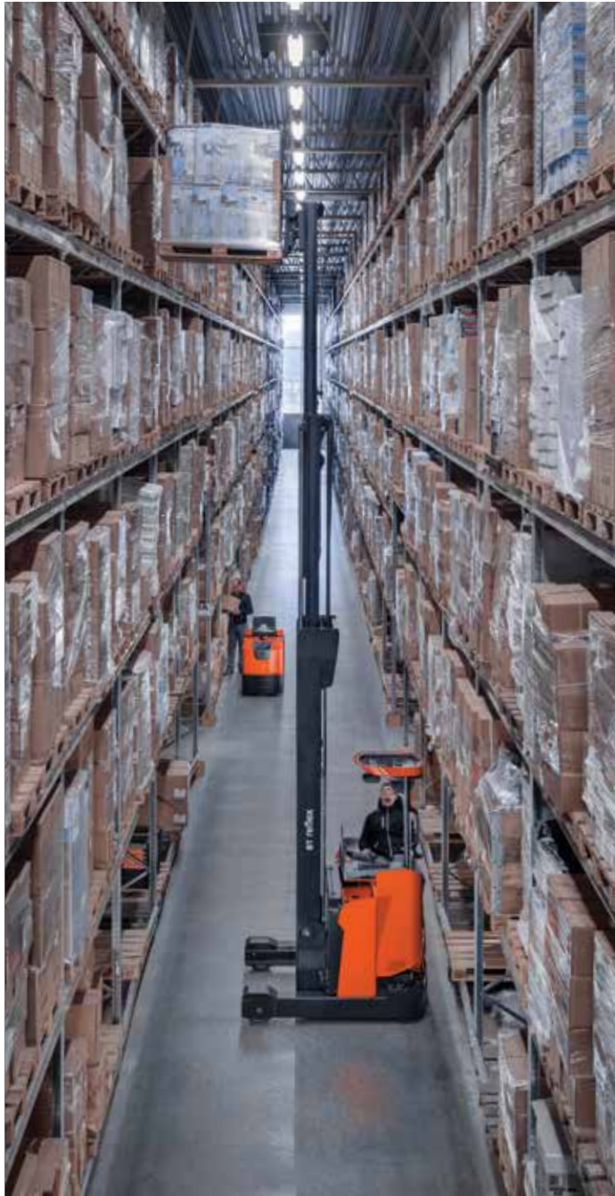
De open vorkwagen met geïntegreerde sideshift biedt een uitstekend zicht naar voren.
