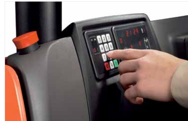
BT toegangscntrole is standaard en voorkomt onbevoegd gebruik
