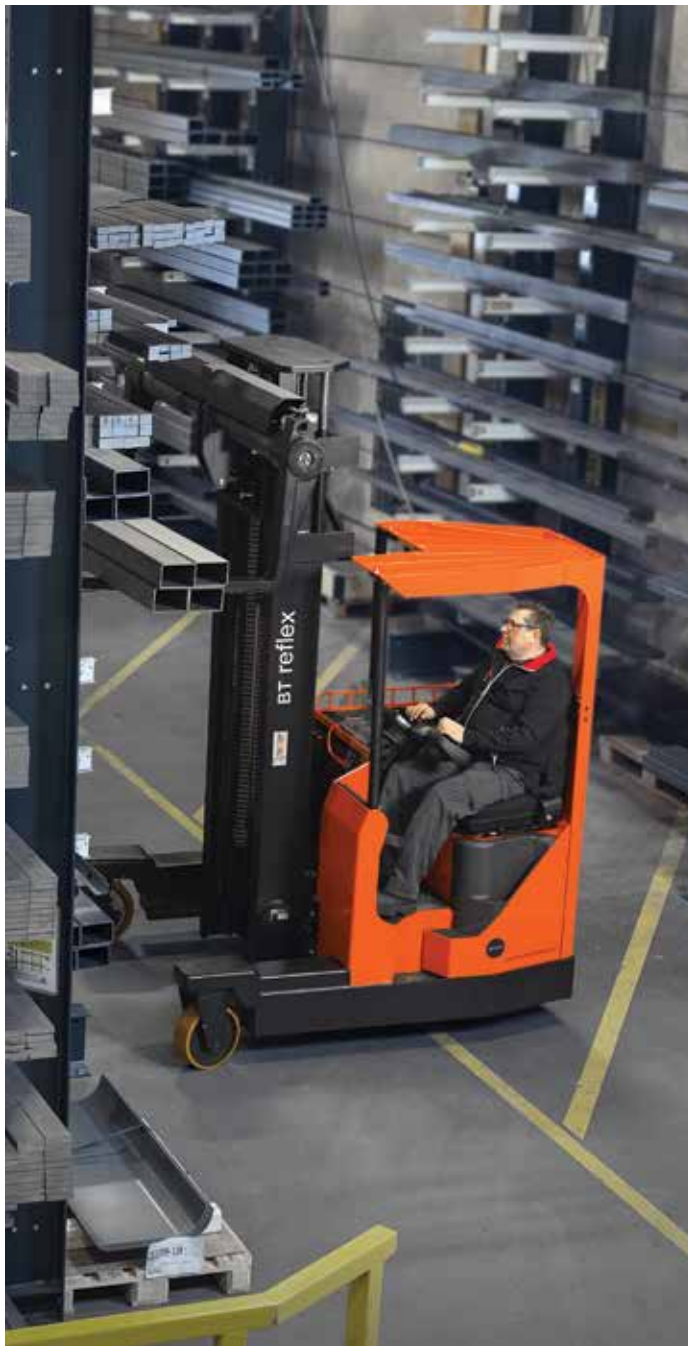
Dankzij de hydraulische vorkspreider op de Reflex F-serie kan de truck snel worden aangepast aan ladingen van verschillende afmetingen
