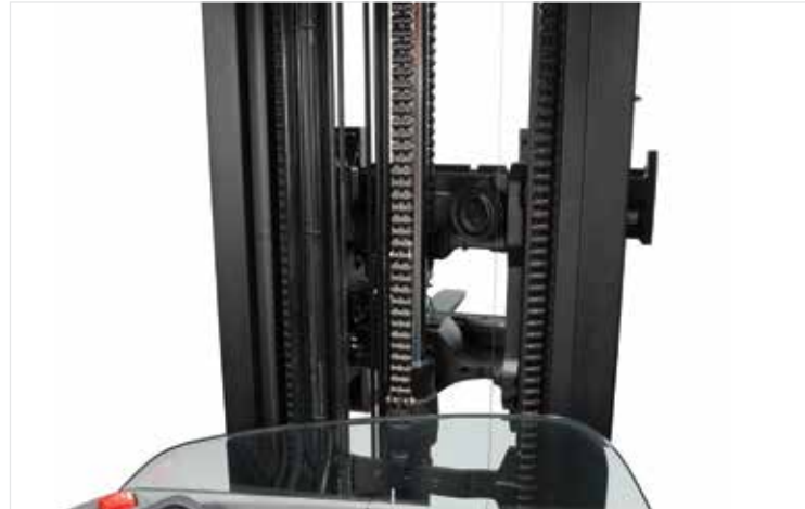
De open vorkwagen met geïntegreerde sideshift biedt een uitstekend zicht naar voren.
