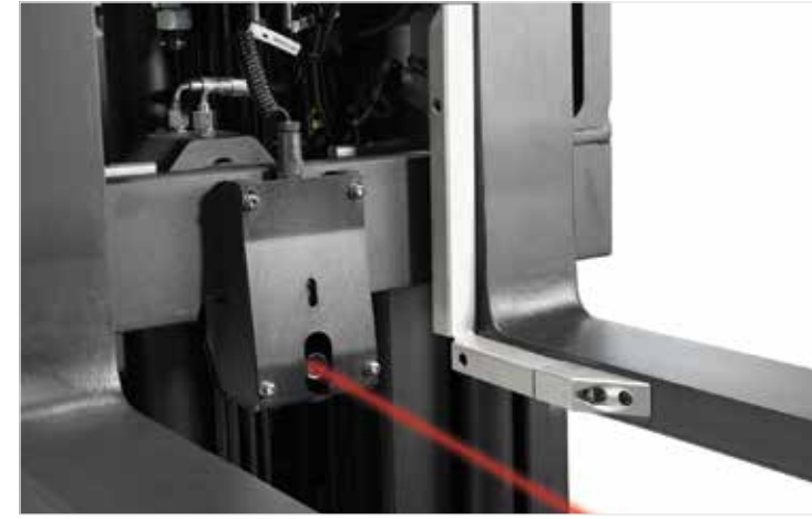
Doordat de vorken gemakkelijker voor de pallets kunnen worden geplaatst met de optionele vorklaser ontstaat er minder schade en blijft de productiviteit hoog.
