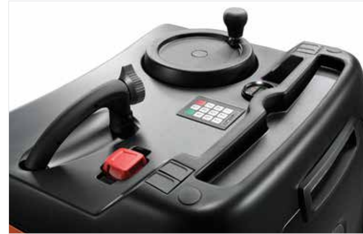
Draaiwielbesturing en toegang via PIN-code
