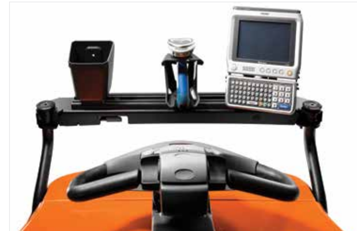
Optionele E-bar voor eenvoudige aansluiting van randapparatuur
