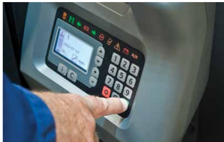
BT toegangscontrole verhindert onbevoegd gebruik en zorgt voor de automatische instelling van de voorkeursparameters bij het starten
