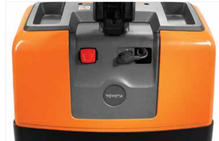
Het bedieningspaneel bevat een uittrekbaar laadsnoer en stekker voor de ingebouwde batterijlader
